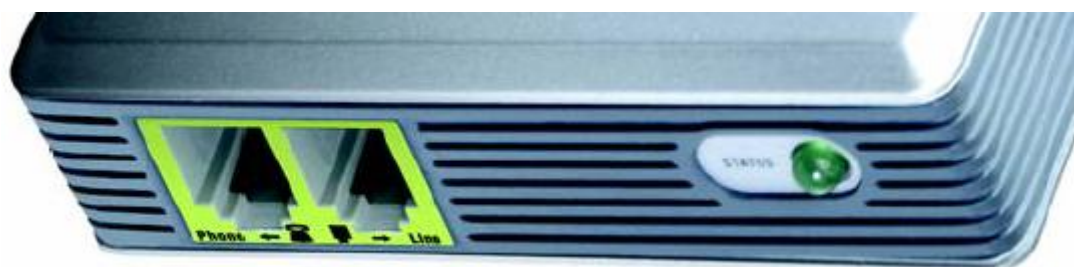
Obrázek č. 1 - zadní strana adaptéru SPA - 3000 Zleva: dva analogové výstupy na telefon a PSTN linku; stavová dioda
